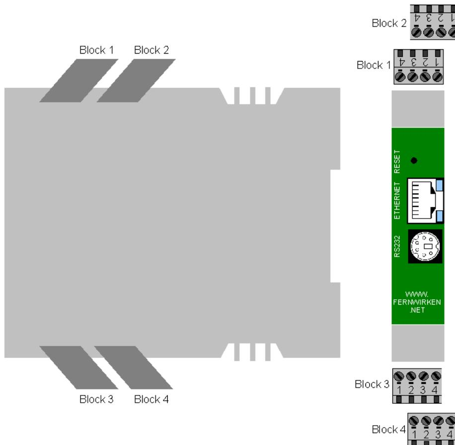
Lage und Belegung der vier Schraubklemmblöcke.
